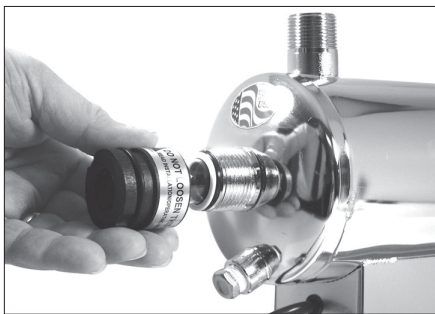
Step 4 - Remove Gland Nuts
